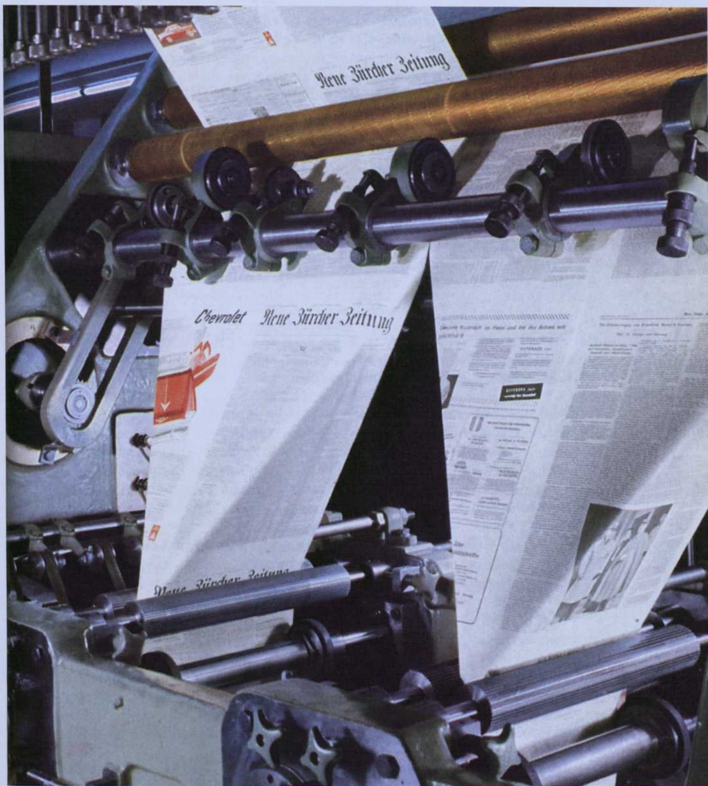
Die Papierstränge laufen über die Falztrichter in den Falzapparat.
