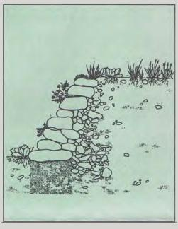
Mit Stützmauern lassen sich Böschungen naturnah absichern. Eine 10 bis 20%ige Neigung und das dränierende Lockergestein hinter den aufgeschichteten Steinen sorgen für eine hohe Stabilität. Eventuell können noch zusätzlich im Mauerfuss eingebaute Dränagerohre den Wasserabfluss verbessern.
