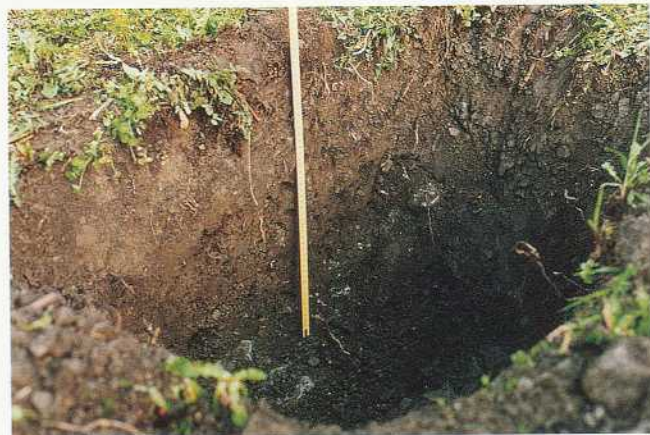
Schlitz 2: Herawingert, 50 m südöstlich des Torkels am Rand des Versuchsfeldes mit diversen Rebenarten, dem Sortengarten. 0,2–0,3 m Humus; darunter gewachsener Bachschutt, d.h. nicht wie im Schlitz 1 als Folge des früheren Weinbaus abgeschwemmtes Material. Boden ziemlich fein, nur wenig grössere Gerölle
