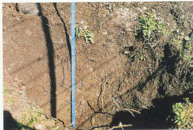
Schlitz 4: Weinberg Egerta (Metteldorf). Bis 0,2 m Tiefe künstlich umgearbeitetes Material. Gewachsener Boden bis 0,4 m Tiefe ziemlich fein; darunter aber gröber als Material von Schlitz 3 (vgl. Abb. 3, Kornverteilung); mehr tafelige Grobkomponenten
