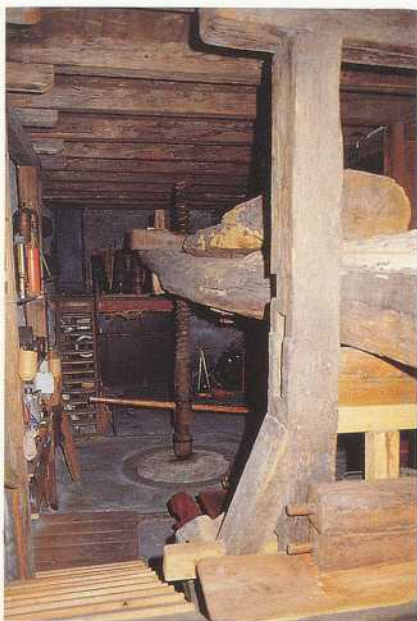
Weinpresse im Roten Haus. Torkelbaum, Vorderdocke und Spindel im Hintergrund. Die zum Bau der Presse verwendeten Eichenstämmen sind im Jahr 1984 dendrochronologisch untersucht worden
