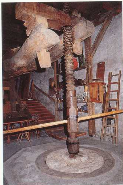
Weinpresse im Roten Haus. Spindel und Mutterstück
