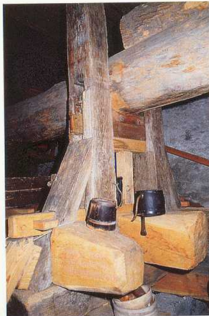
Weinpresse im Roten Haus. Vorderdocke mit Stekhölzern, auch “Esel” genannt
