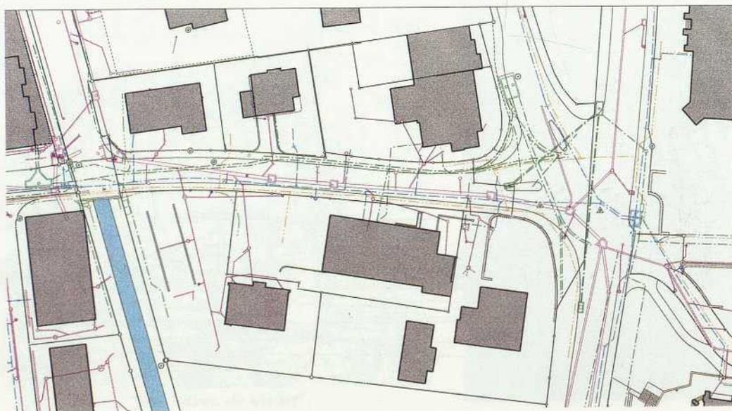
Dank elektronischer Ortung der Leitungen sowie der Speicherung und Berechnung der Daten mittels Computer löst das Werkinformationssystem den Leitungskataster sukzessive ab (Ausschnitt Kirchstrasse zwischen Giessa und Kreuzung beim Regierungsgebäude)
