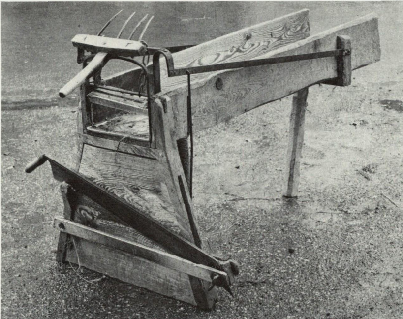
Strohhstuhl, Schneidegerät zum Herstellen von Kurzfutter und zum Zerkleinern der Streue
