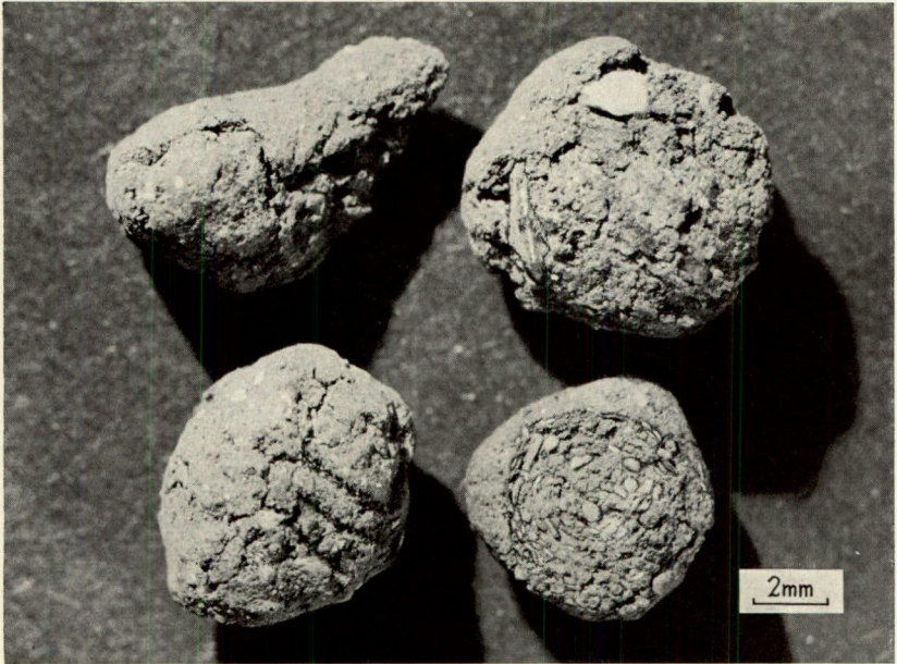
Abb. 1. Typische Rollaggregate aus dem Tonkrug. Oben rechts mit Splitter der Gefäßglasur, unten links mit Krallenabdruck. Das Stück unten rechts ist quer durchgebrochen und zeigt die charakteristische Innenstruktur.
