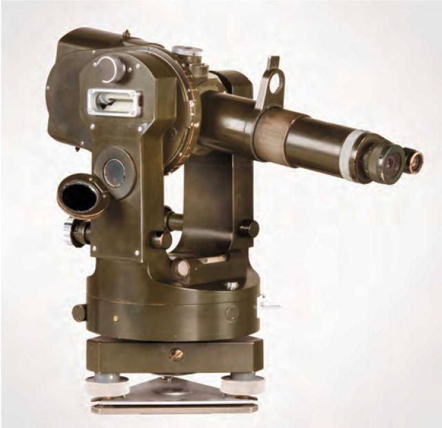
Beim Vermessungsbüro von Hubert Frommelt in Vaduz von den 1950er Jahren bis in die frühen 1970er Jahre im Einsatz: der Doppelbild-Reduktions-Tachymeter Redta 002 von Carl Zeiss. Es war das damals leistungsfähigste Vermessungsgerät dieser Art. Eine Besonderheit war dabei die optische Distanzmessung: Es konnten Distanzen bis 170 Meter in Zentimetrauflösung gemessen werden, wobei die Schrägdistanz automatisch auf die horizontale Länge reduziert wurde.
